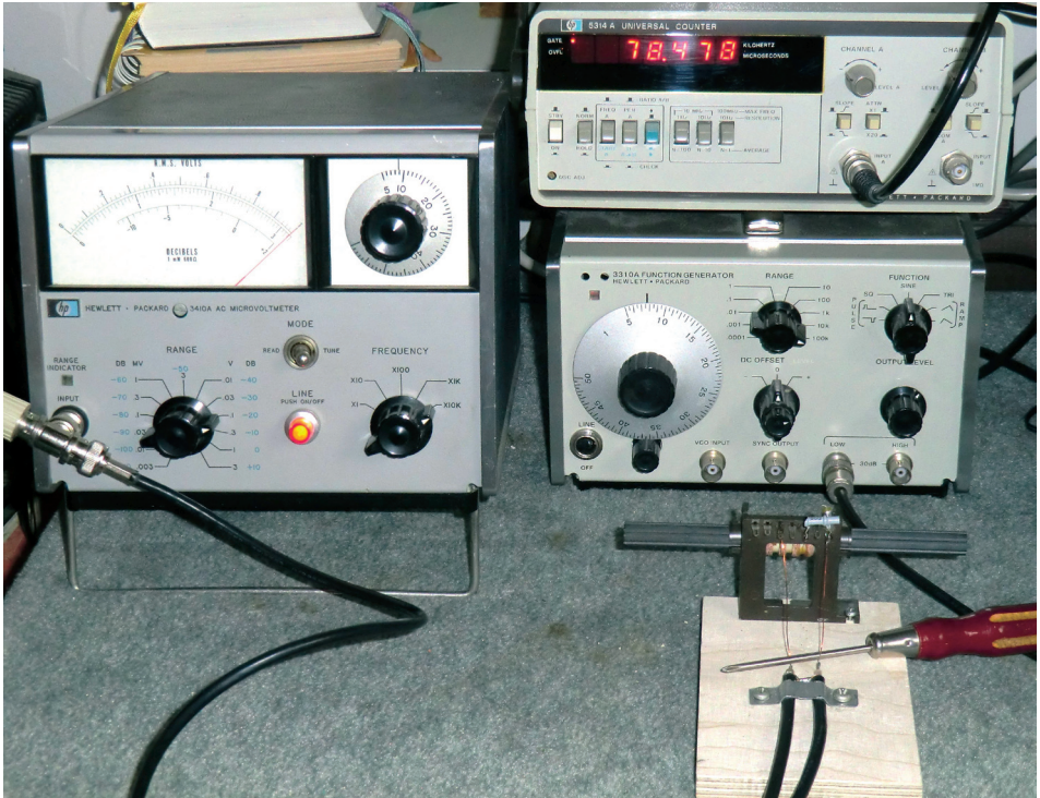
Bild 5: ...so sieht die praktische Messanordnung zur Bestimmung der Spulenverluste und der Güte aus
