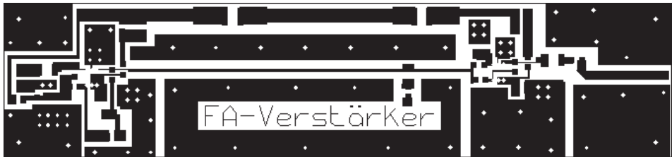
Bild 10: Das Platinenlayout zeigt den erforderlichen Aufwand, wenn hohe Verstärkung auf engem Raum konzentriert wird (... siehe Text)
